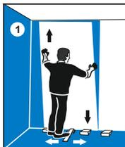
1. Вдоль стены на пол проложите клинья толщиной 10 мм по две штуки для каждого листа. При монтаже на ровное основание, зубчатый шпателем (высота зуба 6 мм) нанесите клей на лист сплошной полосой по периметру и дополнительно две полосы вдоль листа. Прислоните лист с нанесенным клеем к стене и поднимите его вплотную к потолку с помощью рычага.
